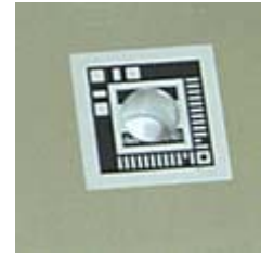
図 5. 試験片の中央に貼り付けられた DMI ゲージ
