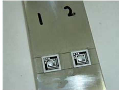
図 7. DMI ゲージがある疲労試験片
